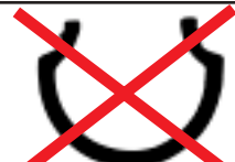
СЛИШКОМ ШИРОКАЯ ПОКРЫШКА/ СЛИШКОМ УЗКИЙ КОЛЕСН. ДИСК
